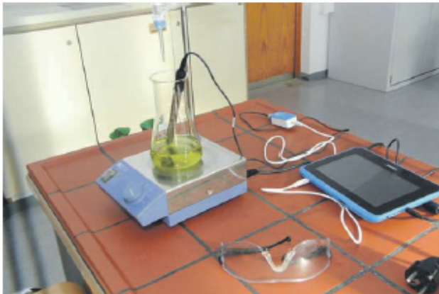
Die mit der Förderung angeschafften Unterrichtsmaterialien, hier Aufnahme einer Titrationskurve. (Foto: ChemieBW).
